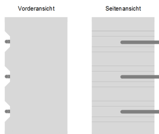
Abbildung 36: Edelstahlspeicher mit seitlichen Anschlüssen, ähnlich wie Variante 2.
