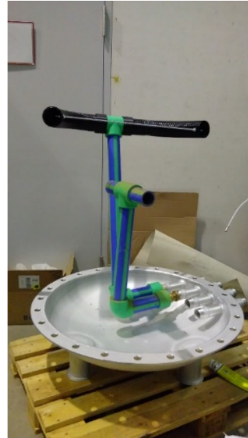
Abbildung 63: Klörperboden mit T-Stück für die Beladung mit Raumwärme (hinten), Entnahme für Raumwärme und WP-Brauchwasserzonen-Erwärmung (Mitte), und zwei freie Anschlüsse für Beladung Kaltwasser und Vorlauf Solar (vorne) sowie Rücklauf Frischwassermodul
