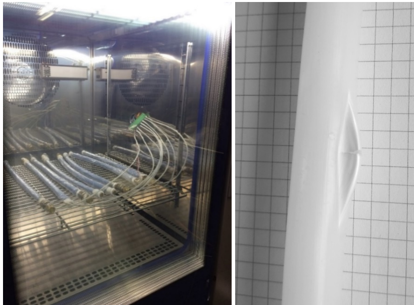
Abbildung 10: Links: Vereisungsversuch mit Rohren im Klimaschrank. Es wurden PE-RT-Rohre mit rundem und ovalem Querschnitt getestet. Rechts: Defektes Rohr mit Ausstülpung, welche geplatzt ist.
