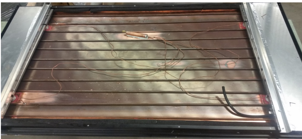
Abbildung 15: Absorberrückseite mit den vier Aktuatoren, verbunden mit dem zentralen Gefäß.
