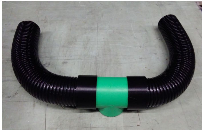
Abbildung 66: Strömungsberuhigung aus einem T-Stück (grün) und Kunststoff-Wellrohren.
