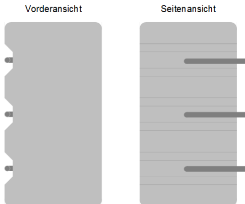
Abbildung 33: Visualisierung der Speichervariante aus Kunststoff mit seitlichen Anschlüssen. Die Anschlüsse werden in die Sicken integriert.
