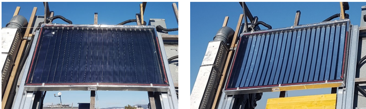
Abbildung 26: Lamellenkollektor auf dem Outdoor-Prüfstand, links mit offenen Lamellen (Absorber ist gut sichtbar) und rechts mit geschlossenen Lamellen (ein grosser Teil des einfallenden Lichts wird von den Lamellen reflektiert).
