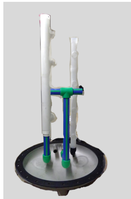
Abbildung 58: Foto des ausgebauten unteren Teils des Speichers mit den Schichtladeeinrichtungen (weisse Rohre) und dem Ansaugstutzen (blau-grünes T-Stück).
