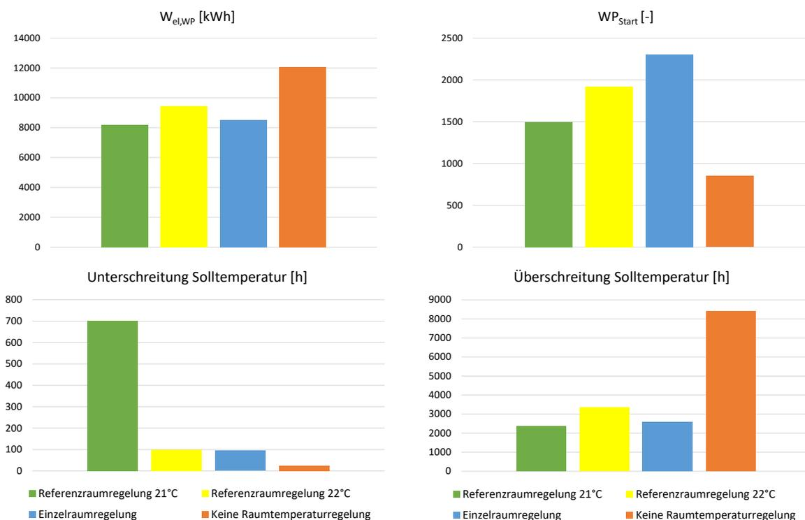
Abbildung 8: Vergleich von Referenzraumregelung, Einzelraumregelung und keine Raumtemperaturregelung mit einer Soll-Temperatur von 21 °C (22 °C) in allen Zonen und einer Vorlauftemperatur bei Auslegung von 30 °C.
