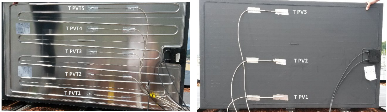
Abb. 27 PVT Modul und PV Modul mit Temperaturfühlern ausgestattet
