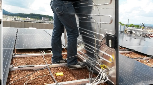
Abb. 14 PVT Kollektor mit Temperatursensoren, im Hintergrund das Pyranometer und die Messeinheit für Windgeschwindigkeit und Richtung
