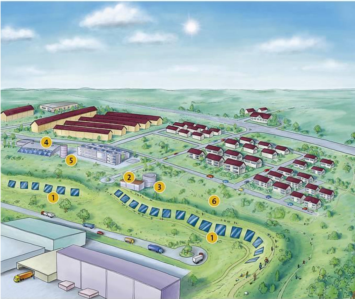
Abbildung 5: Übersicht über das solare Fernwärmenetz Crailsheim. 1. Kollektorfelder auf Lärmschutzwall. 2. Zentrale. 3. Heisswasserspeicher 480 m 3 . 4. Solaranlagensteuerung und Solaranlage auf Dächern. 5. Pufferspeicher 100 m 3 . 6. Erdsondenspeicher. Quelle: Stadtwerke Crailsheim GmbH.
