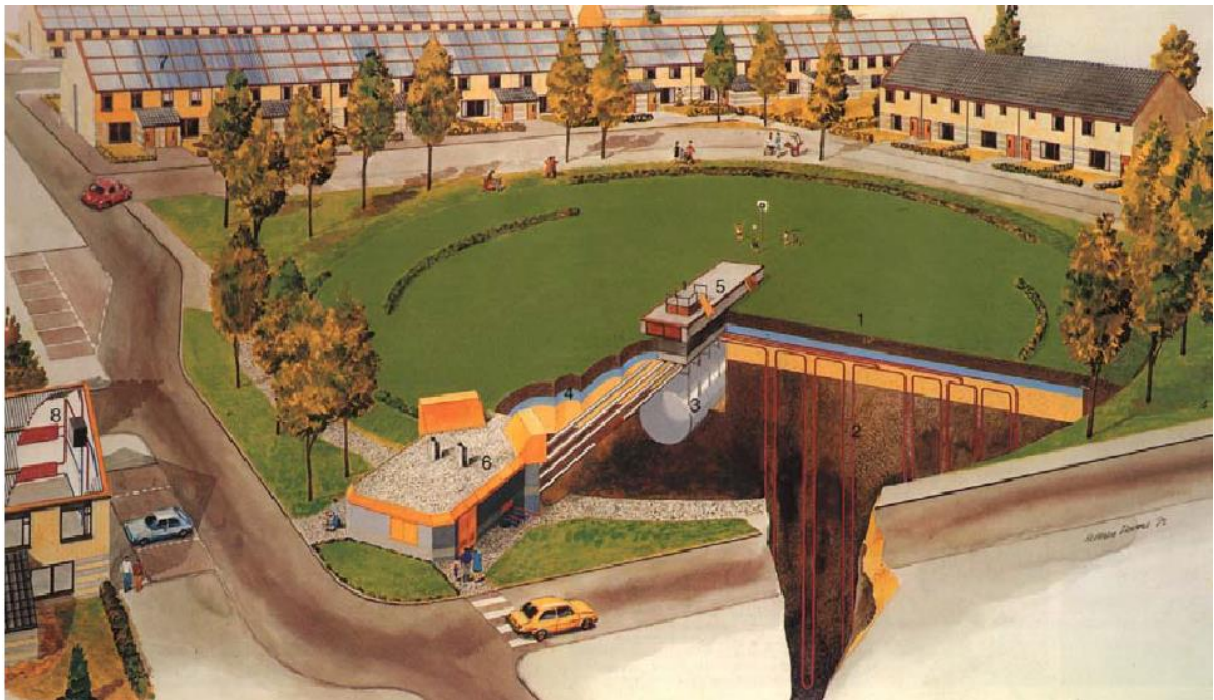
Abbildung 2: Übersichtszeichnung des Groningen Projekts von 1983. Quelle: Aart Snijders, IFTech.
