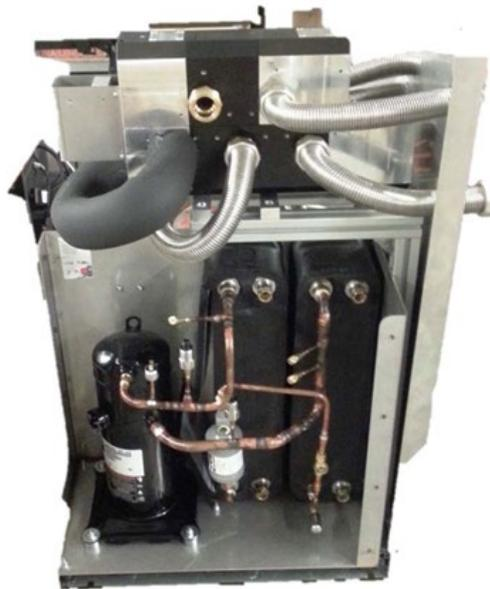
Abbildung 22: Innenansicht der eingesetzten Niedertemperaturhub-Wärmepumpe.
