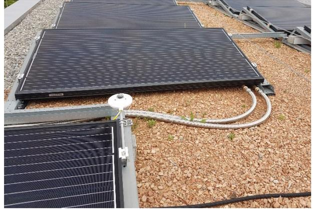
Abbildung 64: Pyranometer in der Modulebene der PVT Kollektoren
