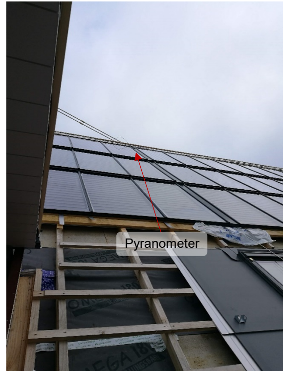
Abbildung 6: Links: Wärmehähler und Volumenstrommessgeräte im Heizkreislauf. Rechts: installiertes Pyranometer auf dem Dach.
