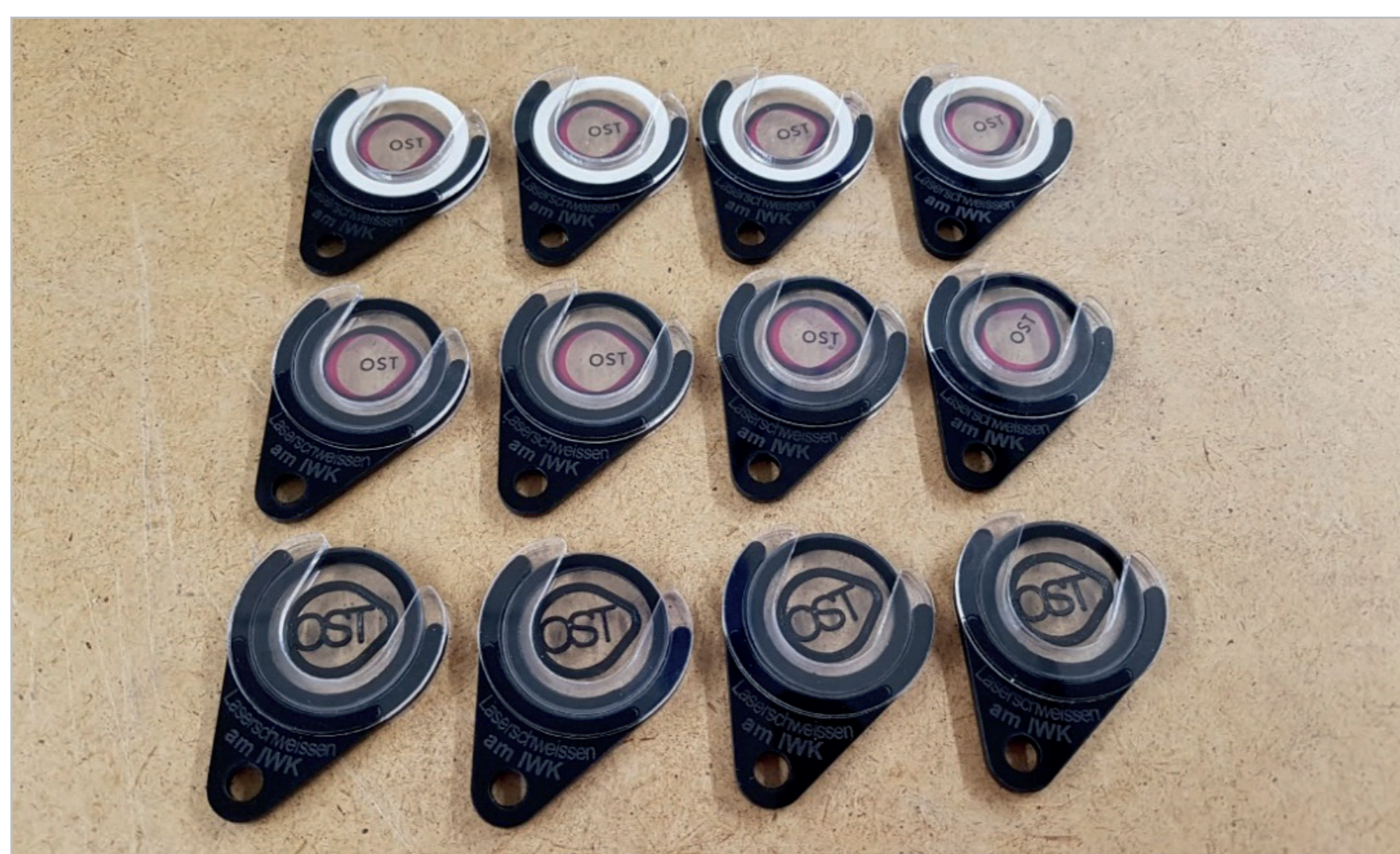
3 | Mehrschichtige lasergeschweusste Münzenträger und Kunststoffmünzen (Semesterarbeit J. Schmid)
