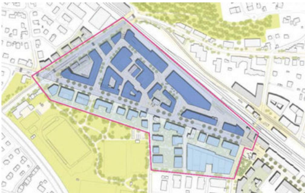
Abb. 82: Masterplan mit Regenwassermanagement auf Flachdächern (blau mit Einstau), Zentrumsentwicklung Gümligen (Quelle: Metron, ergänzt ILF)
