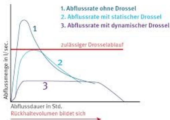
Abb. 71: Prinzipskizze: Drosselung des Abflusses (Quelle: T. Oesch)
