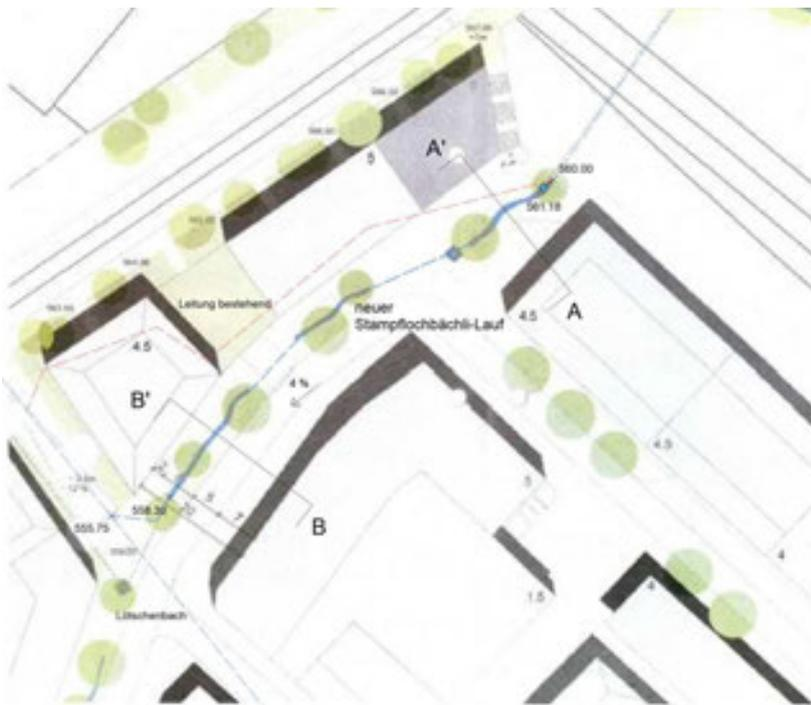
Abb. 84: Die bestehende Ableitung des Stampflochbächli (rot) bleibt bestehen. Der neue, dotierte Bachlauf ist auf drei Abschnitten offengelegt und erlebbar (blau durchgezogen), verläuft aber zugunsten der Zugänglichkeit der Gebäude teils unterirdisch (Quelle: Metron)
