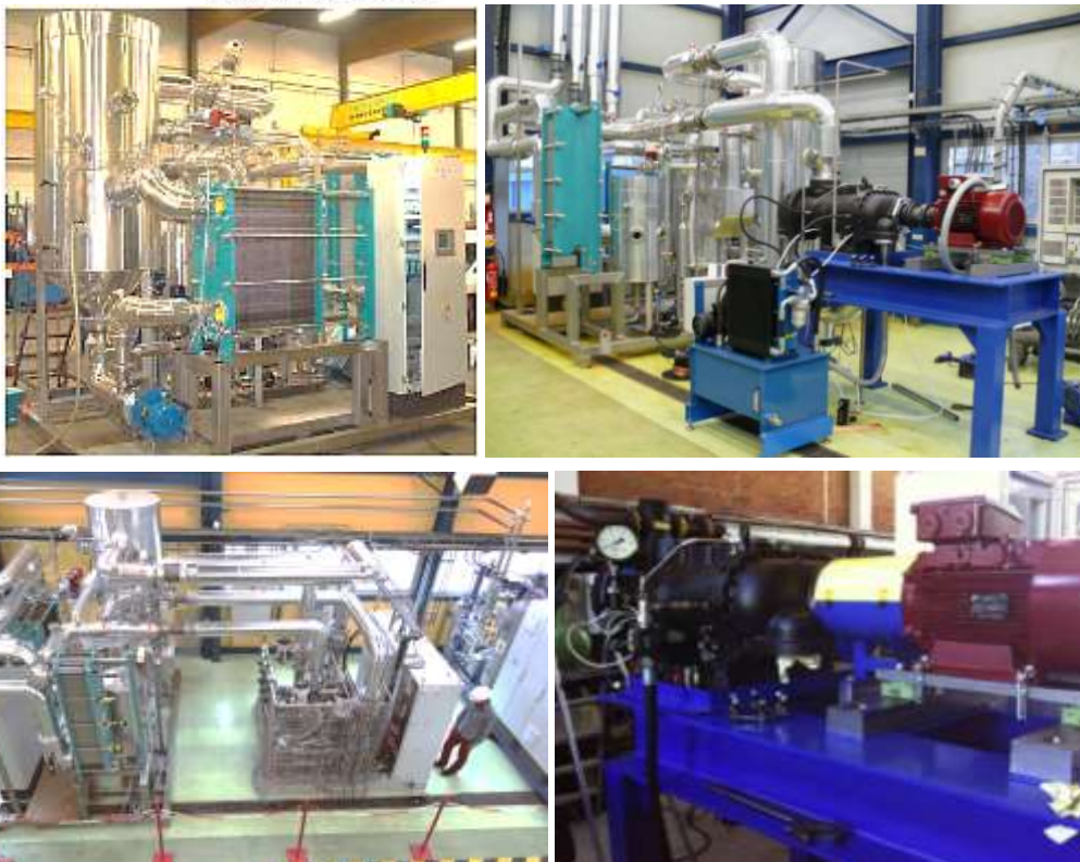
Abbildung 82: Schema und Fotos der Wasser (R718) HTWP des PACO Projekts mit Doppelschraubenverdichter (Chamoun et al., 2014, 2013, 2012b; EDF, 2015; IEA, 2014a).
