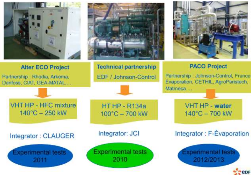
Abbildung 75: Entwicklungsprogramme für HTWP in Frankreich (IEA, 2014a; Jakobs and Laue, 2015; Peureux et al., 2014).
