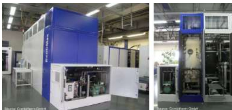
Abbildung 28: Integration einer HTWP mit R245fa in eine industrielle Teilreinigung, Wärmepumpe entwickelt in Zusammenarbeit mit der Dürr Ecoclean GmbH und der Combitherm GmbH mit Hubkolbenverdichter, 45 kW Nennheizleistung, 110°C Verflüssigungstemperatur, Druckverhältnis 4.3 (Blesl et al., 2014).
