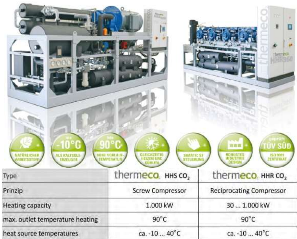
Abbildung 23: CO 2 Wärmepumpen thermeco 2 mit Schraubenkompressor (Model HHS, links) und mit Hubkolbenkompressor (Model HHR, rechts) (IEA, 2014a; Thermea, 2012).
