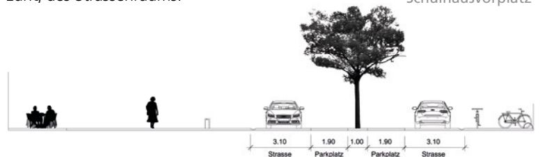
Querschnitt A-A Schulhausvorplatz
