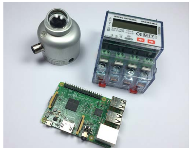
Abbildung 4 Beispiel kostengünstiger (CHF 600) und hochgenaue Messhardware für Aussentemperatur, Strahlung, Elektrische Daten für PV-Überwachung und Eigenverbrauchssteuerung und Visualisierung
