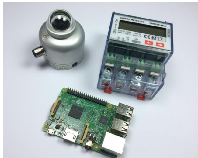
Abbildung 4 Beispiel kostengünstiger (CHF 600) und hochgenaue Messhardware für Aussentemperatur, Strahlung, Elektrische Daten für PV-Überwachung und Eigenverbrauchssteuerung und Visualisierung
