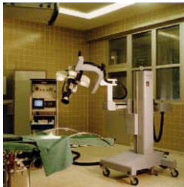
Telemanipulator für TV-Übertragung in den Hörsaal
