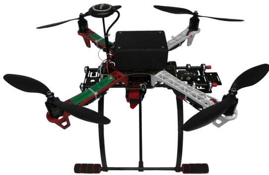
DJI Flame Wheel F450 Quadcopter mit dem integrierten LTE-Modul
