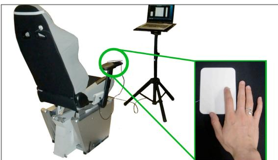
Biofeedback-Modul integriert im aktuellen TRC-Prototyp. Position und Handhabung des Sensor-Pads sind hervorgehoben
