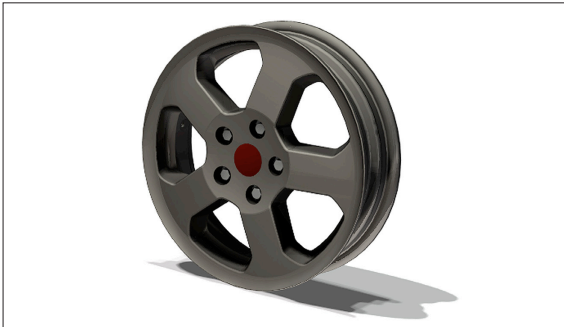
12"-Leichtbaufelge mit Einleger und Nabendeckel
