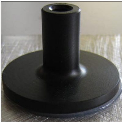
Auf ein Alu-Substrat geklebter PA-Onsert
