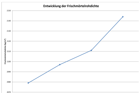
Die Erhöhung der Frischmörtelrohddichte durch die Zudosierung von verschiedenen Mengen an Steinkohleflugasche im Vergleich zum Ausgangsmaterial
