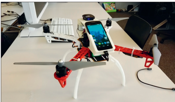
Aufgebauter Prototyp einer Lieferdrohne mit Smartphone-Halterung
