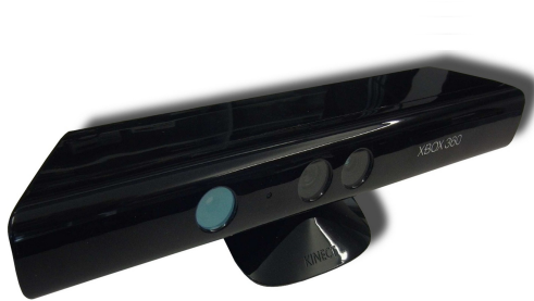
Kinect Sensor der Firma Microsoft. Er enthält eine Farbkamera, einen Tiefenbildsensor und ein Mikrofonarray.
