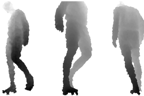
Tiefenbilder einer Person aus verschiedenen Perspektiven. Schwarze Bereiche sind nah, weisse weiter entfernt.
