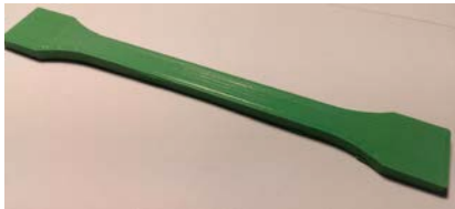
Abbildung oben: 3D-Drucker „Deltatower“ Abbildung unten: 3D-gedruckter Zugstab
