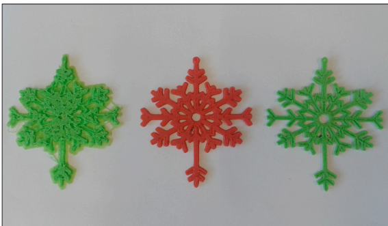
Gedruckte Schneeflocken vor (1) und nach (2+3) der Softwareautomatisierung
