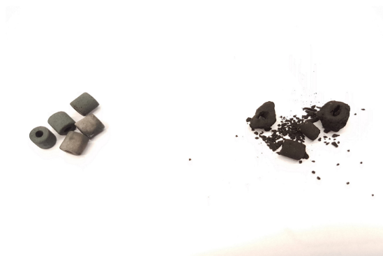
links: neue Katalysator Pellets, rechts: Pellets nach einer Betriebszeit von 15 h
