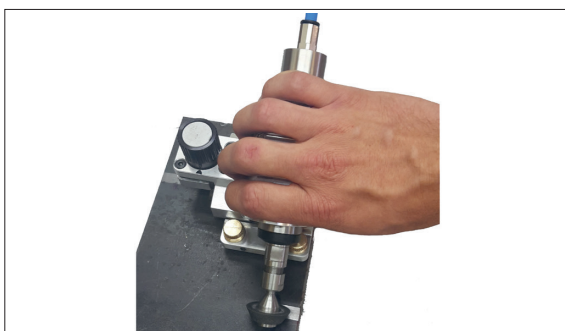
Abbildung 3: Manuell bedienbare Vorrichtung zum Nachbearbeiten von Entlüftungsnuten
