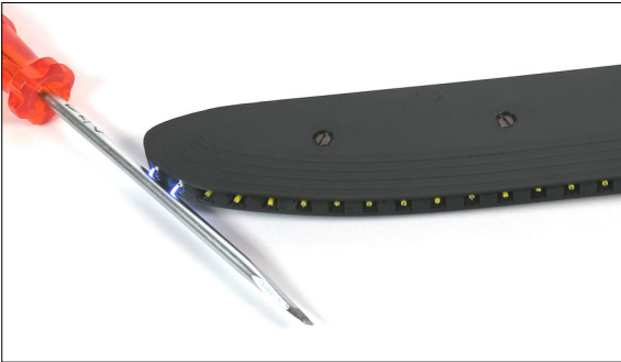
Das Messer in Aktion: 7'000 Volt entladen sich zur Demonstration über einen Schraubenzieher. Eigene Darstellung
