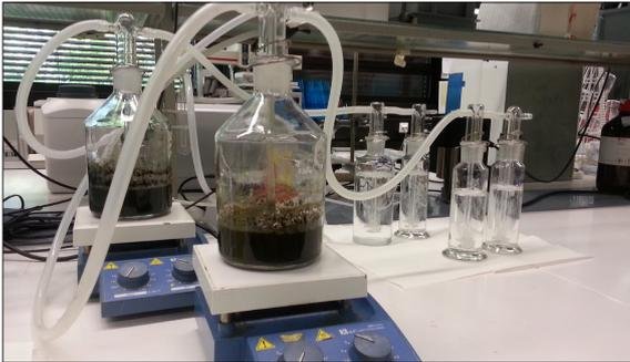
Versuchsaufbau Impinger-Verfahren für die Erfassung der Ammoniakfreisetzung im Gärgut
