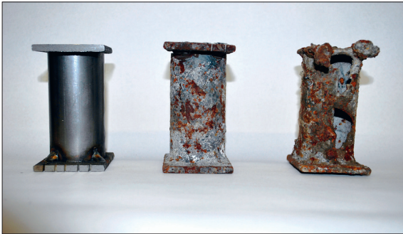
Prüfkörper für die Grossversuche: links vor dem Versuch, in der Mitte nach dem Durchlauf durch die KVA und rechts durch thermische Oxidation zerstört
