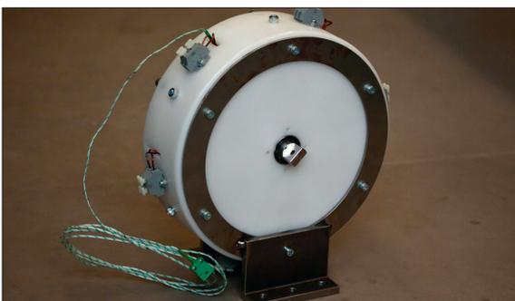
Fertiggestellter Generator mit Halterung für den Motorenprüfstand
