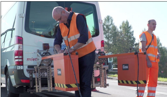
Installation der Georadarantennen
