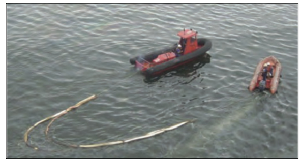
Ölsperre mit integriertem Sorptionsmittel gezogen von zwei Booten ITOPF Ltd, «Technical information Paper 8»
