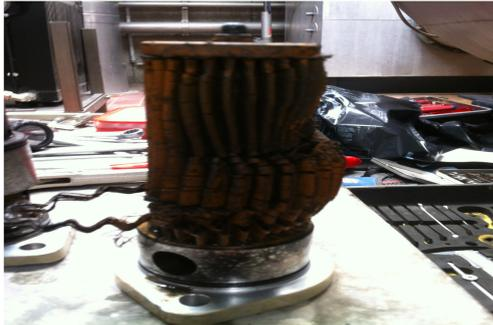
Interne Ölfilter einer Biogasaufbereitung, stark korrodiert
