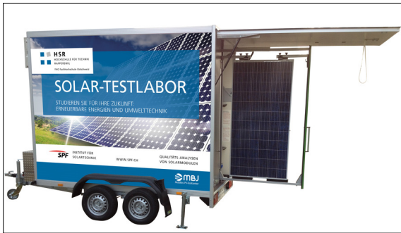
Mobiles Testlabor der HSR zur Messung von IV-Kennlinien von Photovoltaik-Modulen.
