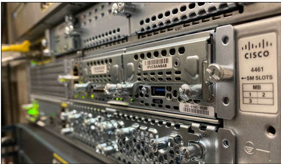
Cisco ISR 4461 mit zwei UCS E-Series Server Blades Eigene Darstellung
