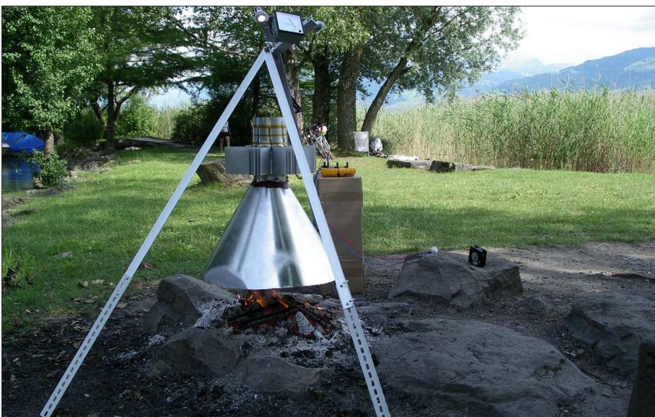
Thermoelektrischer Generator im Einsatz: Die elektrische Leistungsausbeute beträgt 8–10 W.
