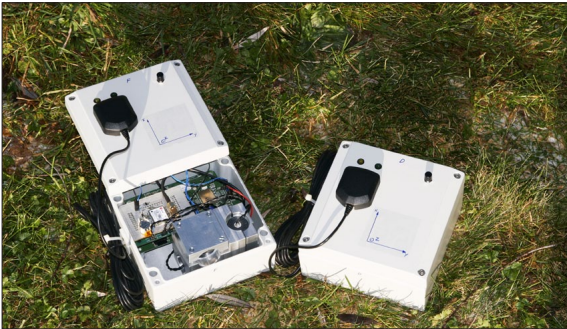
Zwei Erschütterungsmessgeräte aus dem Geophon-Netzwerk
