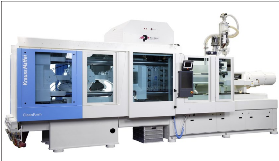
Krauss-Maffei-Spritzgiessmaschine (Typ: 100-380 CX) am Institut für Werkstofftechnik und Kunststoffverarbeitung an der HSR
