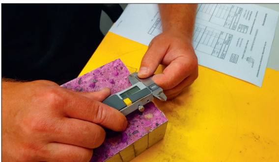
Nullmessung der Karbonatisierungstiefe
