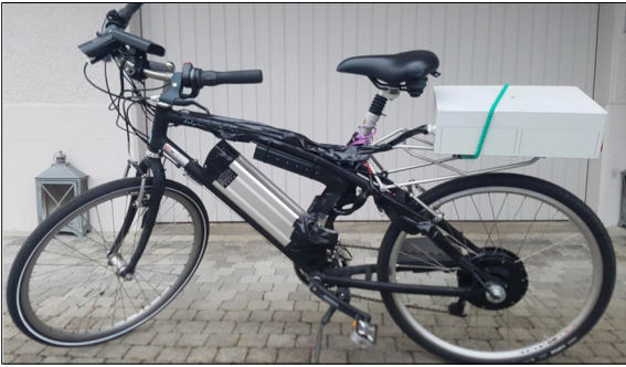
Umgebautes e-Bike mit Batterie und Suprkapazitäten.
