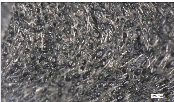
Abbildung 3: Schaumstruktur GV-5H mit Treibmittel A (100x Zoom)
