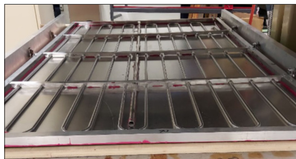
Auf diesem Bild sieht man die Rückseite des Moduls. Gut sichtbar ist der Schlauch, in welchem das Fluid zirkuliert. Bericht 2020, PVT-Kollektor, SPF Rapperswil
