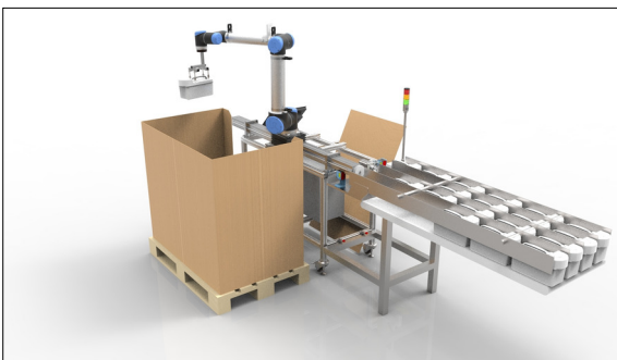
Virtuelles Produkt der entwickelten Roboteranlage mit der Kartonkiste und dem Zuführband
