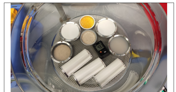
Proben im Exsikkator Eigene Darstellung
