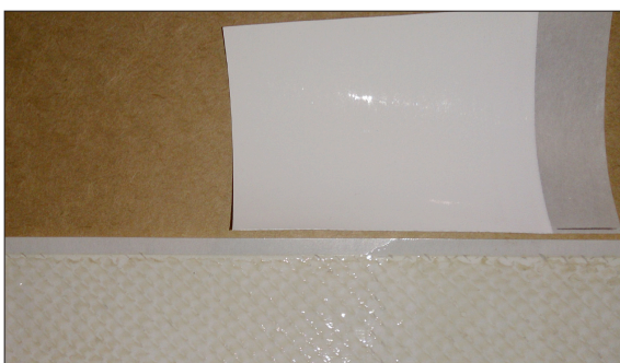
Unbenutzte und mit Fouling-Schicht bedeckte Nanofiltrationsmembran
