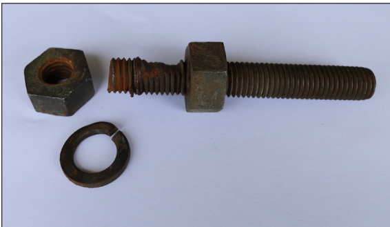
Abgebrochenes Gewinde von einem defekten Hängestab Eigene Darstellung
