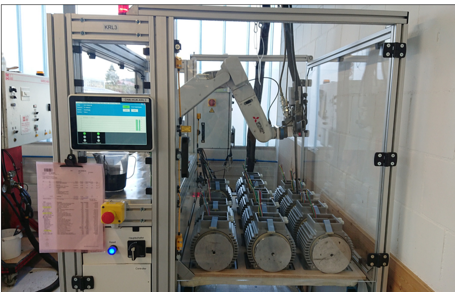
Vollautomatische Vergussanlage im Betrieb Eigene Darstellung
