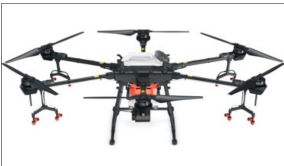
AGRAS T20 - Beispiel einer Drohne mit 20kg Payload, welche gemäss den erarbeiteten Anforderungen umgebaut werden könnte Da-Jiang Innovations Science and Technology Co., Ltd
