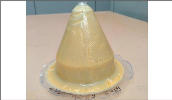
Ergebnis des RTM-Versuches ohne angepasstes Werkzeug
