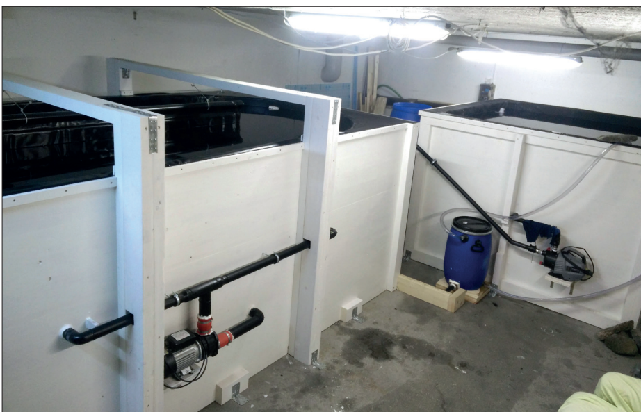
5000-l- und 10000-l-Wasserbecken, welche für die Versuchsanlage selber gebaut wurden
