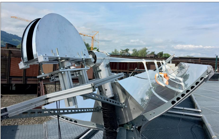
Verschattungskonstruktion, installiert mit dem Parabolrinnen-Kollektor, auf dem Dach des Gebäude 2 an der HSR
