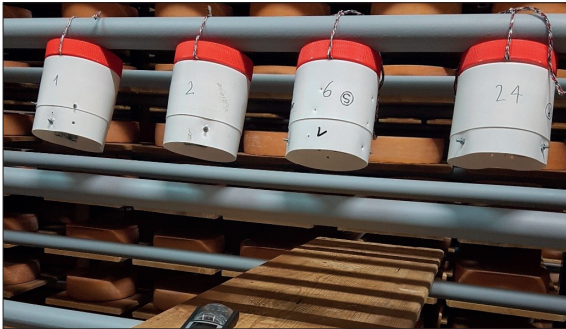
Aufhängung der Messgeräte im Käsekeller in Urnäsch
