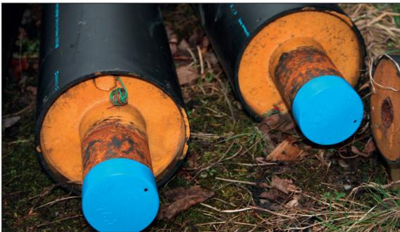
Kunststoffmantelverbundrohre mit den in der PUR-Isolierung eingelassenen Messleitungen für die Lecküberwachung
